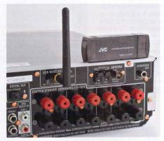
■ L'antenna wireless e il suo trasmettitore, da inserire nella presa USB di un computer. Le prestazioni sono limitate, sono trasmessi solo segnali audio già avviati in precedenza sul PC e la portata è limitata, molto rapida invece la procedura di riconoscimento del trasmettitore.
